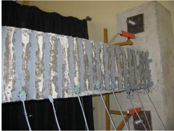
Şekil 7 - Dıştan CFRP çubuk uygulaması
