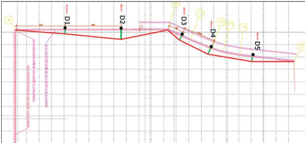
Şekil 11 - İnklinometre kuyuları yerleşim planı ve yatay deplasman okumaları (kırmızı çizgi, abartılı gösterim)
