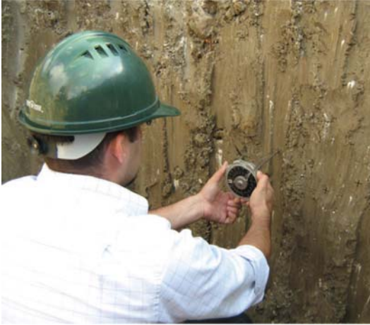
Şekil 1 - Muayene kuyusunda Vane Deneyi
