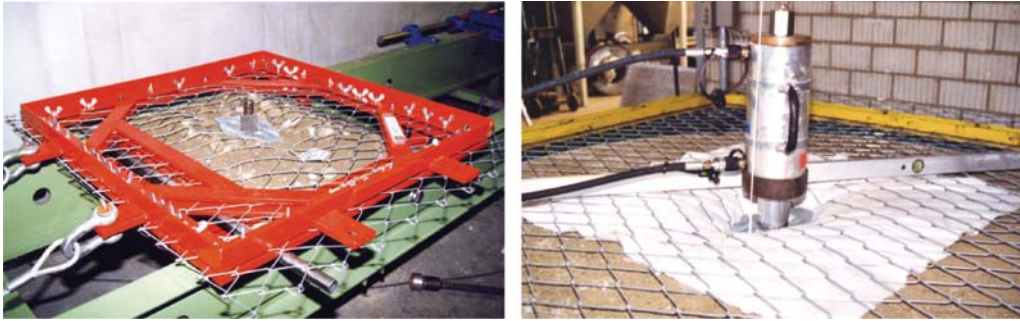
Şekil 6 - Ağın şeve paralel seçilmiş çekme gerilmesine karşı dayanma direncini belirlemek için test düzeneği (solda) ve ağın çivi yönünde delinmeye karşı dayanma direncini belirlemek için test düzeneği (sağda)
