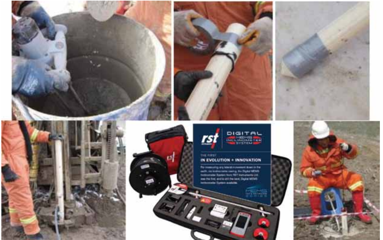
Şekil 2 - Düşey ve Yatay İnklinometre Borusu Yerleştirme Hazırlıklarından Genel Görünüş
