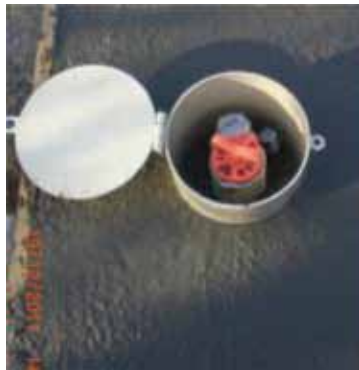
Şekil 4 - Tipik İnklinometre Koruma Kapağı ve Künyesi
