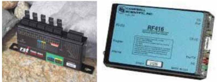
Şekil 12 - Multiplexer FlexiMUX ve RF Spread-Spectrum Radio/Modem Genel Görünüş
